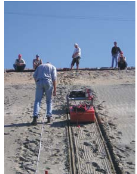
→ ABB. 30 Bodenradar-Untersuchungen auf einem Sanddamm
