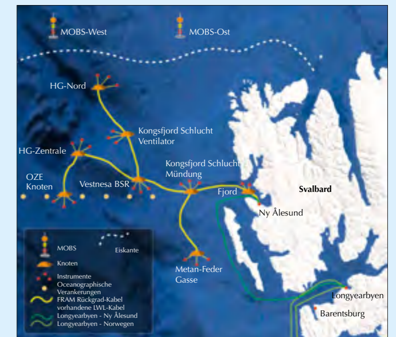
Schematische Darstellung des geplanten multidisziplinären FRAM (FRontiers in Arctic marine Monitoring) observatory westlich von Spitzbergen. Autonome Messsysteme und neue Sensor-Pakete werden ebenso installiert wie ein Satelliten-Kommunikationssystem, welches einen Echtzeit-Datentransfer ermöglichen wird. Grafik: N. Lochthofen, AWI
