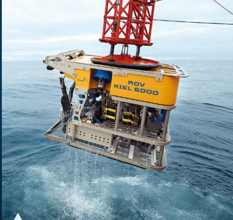
Augen und Arme in der Tiefsee: Ferngesteuerte Tiefseeroboter wie das ROV KIEL 6000 ermöglichen eine zielgenaue Erkundung und Erprobung von Rohstofflagerstätten, wie zum Beispiel Hydrothermalsysteme. Foto: Bernd Grundmann
