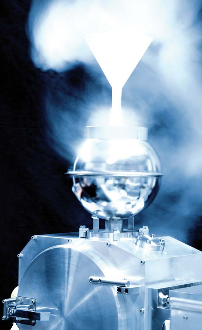
Kühlfalle am Thermionen-Massenspektrometer „TRITON“ beim Befüllen mit flüssigem Stickstoff. Foto: Pohl/Warnk/Gall
