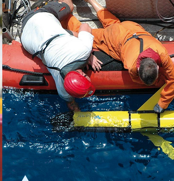
Segelflugzeuge der Meere: Mit ozeanografischen Gleitern werden wertvolle Informationen über die zeitliche und räumliche Struktur der Ozeane gewonnen. Das GEOMAR betreibt eine der größten Gleiterflotten Europas. Foto: Michael Schneider, FS METEOR
