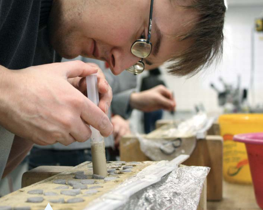
Klimaarchiv Meeresboden: Sedimentkerne sind vertikale Ausschnitte des Meeresbodens. Genaue Analysen ihrer chemischen Zusammensetzung liefern Daten über das Klima in vergangenen Zeiten. Foto: Katja Machill, GEOMAR
