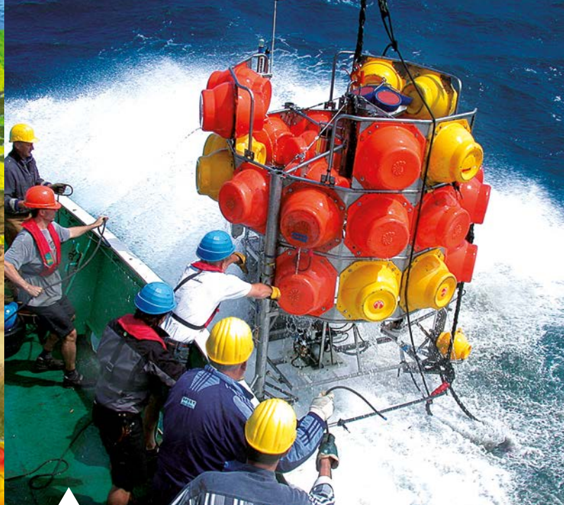
Biogeochemisches Observatorium: BICO-Lander werden für die Untersuchung von Austauschprozessen zwischen Sediment und Wassersäule eingesetzt. Foto: GEOMAR
