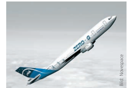
Der Airbus A300 ZERO-G erzeugt mit seinen Flugmanövern pro Parabel 22 Sekunden Schwerelosigkeit, die für Forschungen genutzt werden kann
