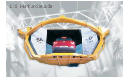
Der dynamische Fahrsimulator des DLR bietet ein realistisches Fahrgefühl
