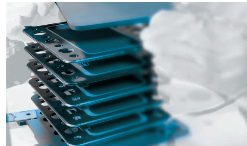
Montage einer Hochtemperatur-Brennstoffzelle in Kassettenform
