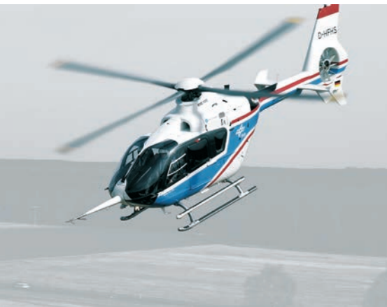
Fliegender Hubschrauber-Simulator (ACT/FHS) mit Fly-by-Light- und Fly-by-Wire-Steuerung
