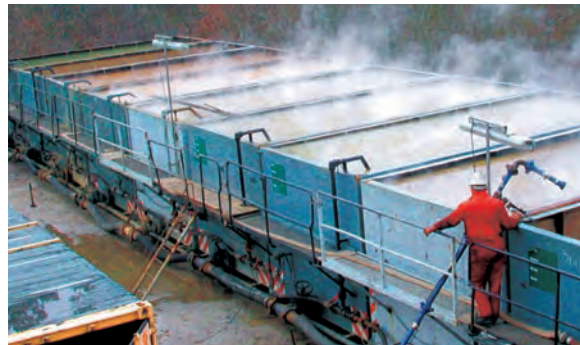
Fördertest in Groß Schönebeck: heißes Wasser aus 4300 Metern Tiefe
